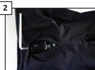
Suite à l'activation du système mécanique (gonflage de l'airbag), la bille a été éjectée et le ressort est visible. Dévissez la cartouche CO<sub>2</sub> vide et retirez-la.
