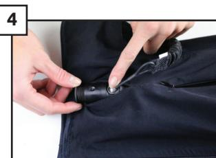
Replacer la bille dans son logement. L'anneau autour de la bille doit être positionné bien à plat. Commencez à visser le bouchon à la main tout en maintenant fermement la bille.
