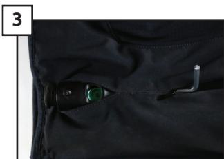
Remettez le piston en place à l'aide de la clé Allen ou de votre doigt. Veillez à ce que l'encoche du piston soit bien en face du trou où viendra se placer la bille.
